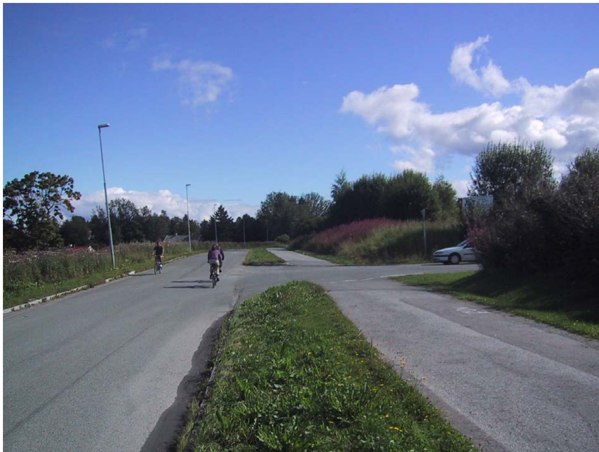
Figur 4: Veg med uklar status. Det er ikke skiltet G/S-veg på det som tilsynelatende er G/S-veg. Det er skiltet med vikepliktsskilt på sideveg, foran G/S-veg, og det er kantstein mellom kjørebane og "G/S-veg". Hvem har vikeplikt for hvem?
