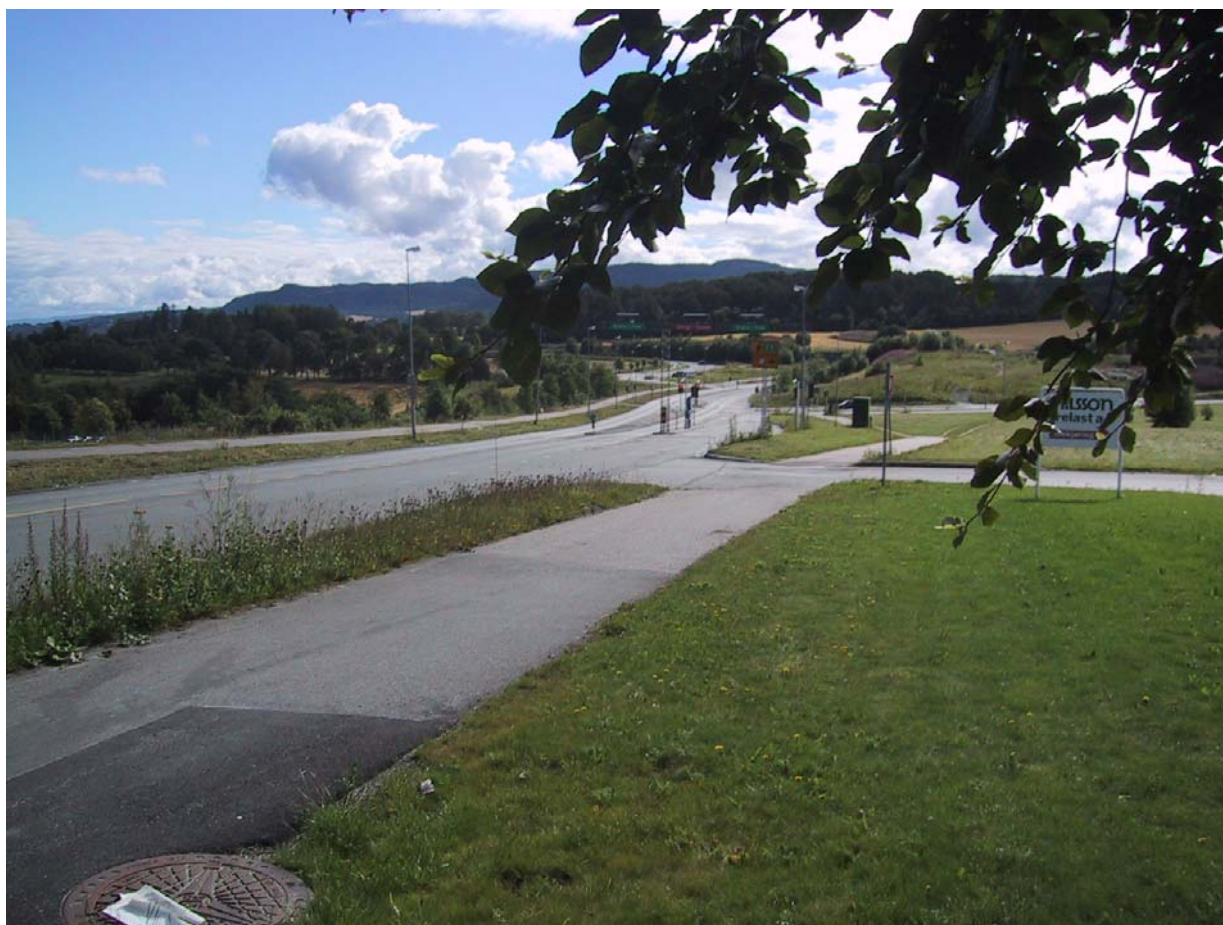
Figur 5: Kryss eller avkjørsel? Her er inn- og utkjøring til trelastfirma skiltet med vikeplikt, noe som signaliserer at dette ikke er en avkjørsel. Dette kan skape forvirring.
